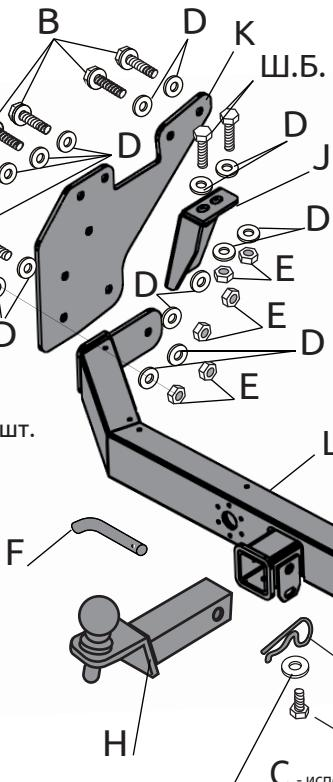
Ш.Б. - штатные болты установленные на автомобиле.
